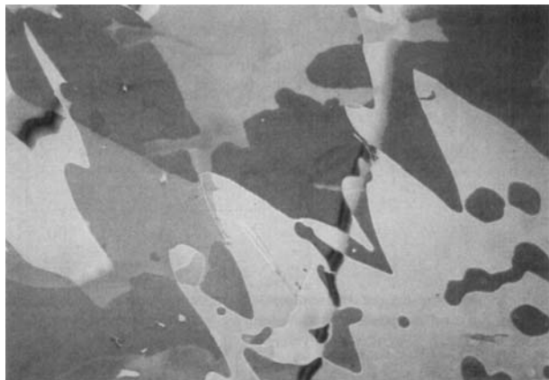
Abb. 6. Polarisationsmikroskopische Aufnahme des biaxial nematischen Polymers Poly[1-([11-2,5-bis( p -anisoyloxy)phenyl]undecyloxycarbonyl)-1-methylethylen] (gekreuzte Polarisatoren, Vergrößerung 17,5fach). Originalfarben: hauptsächlich rotviolett, hellbraun, lindgrün.
